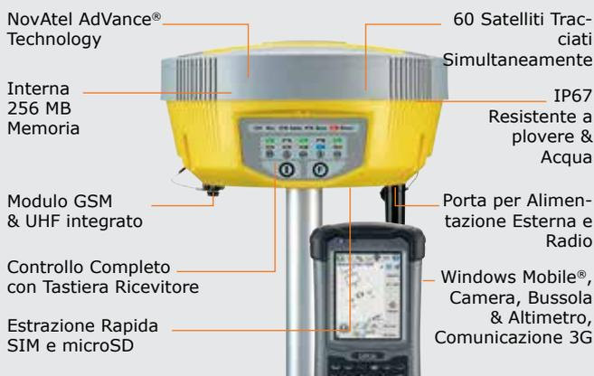
I ricevitori Zenith10/20 sono a prova di futuro, sfruttando i benefici dell'innovativa tecnologia NovAtel AdVance® che supporta i sistemi GNSS GPS, Glonass, Galileo e BeiDou
